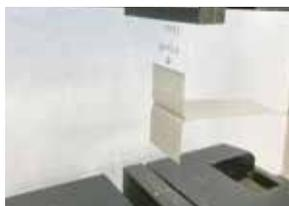
剥離強度: 10 N/25mm(凝集破壊)
